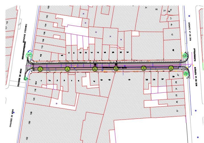
De boordstenen zullen uitgevoerd worden in massa gekleurde beton; een imitatie van «blauwe steen» en de straatgoten zullen bestaan uit standaardelementen in beton.
